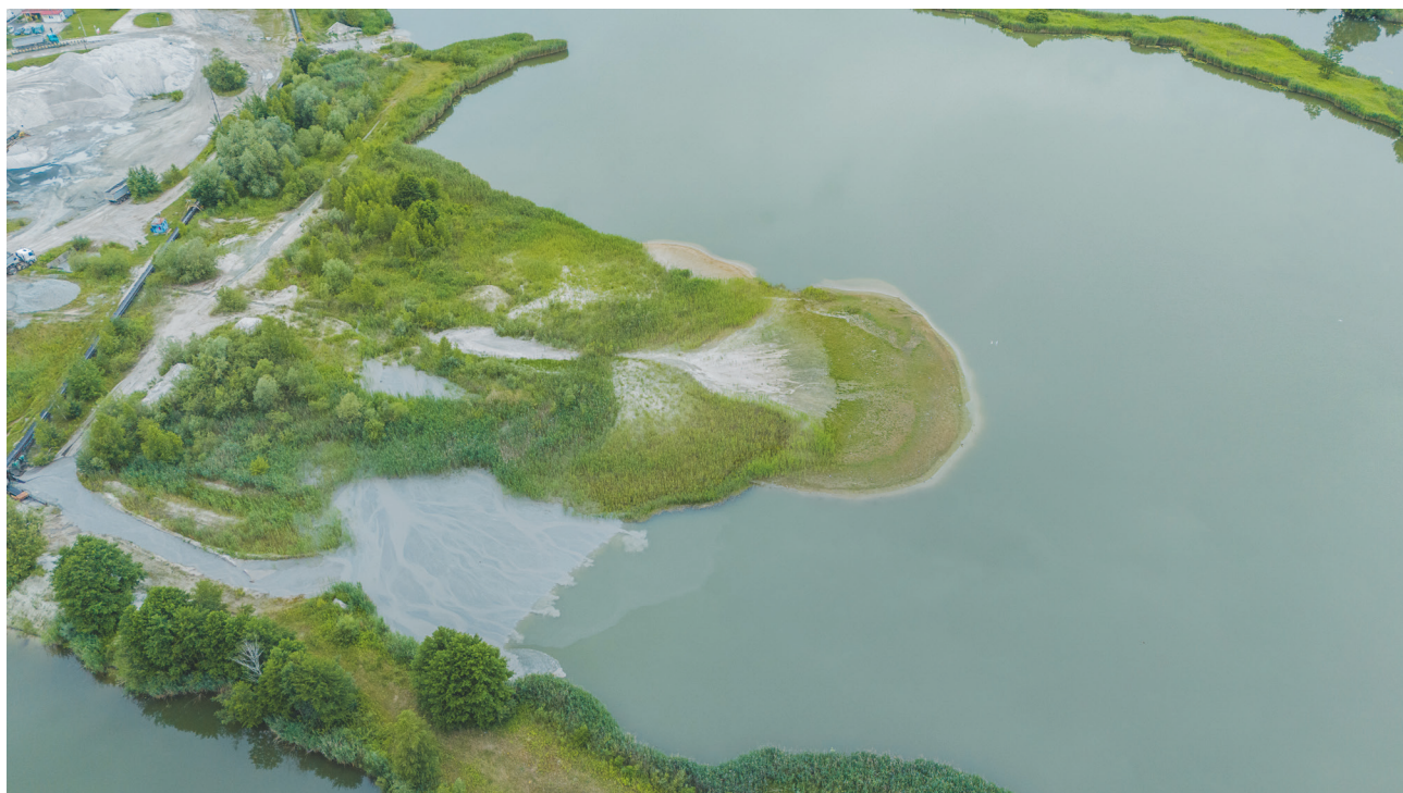
Wypłylenie w kopalni „Zakole B” w miejscu odprowadzania wód poprocesowych do wyrobiska, fot. J. Góra
